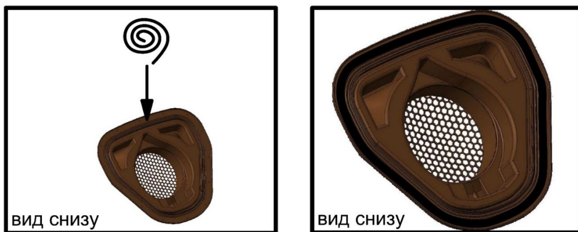
Рисунок Е.6 – Установка бутылкаучукового шнура в канавку основания аэратора NEXT.
