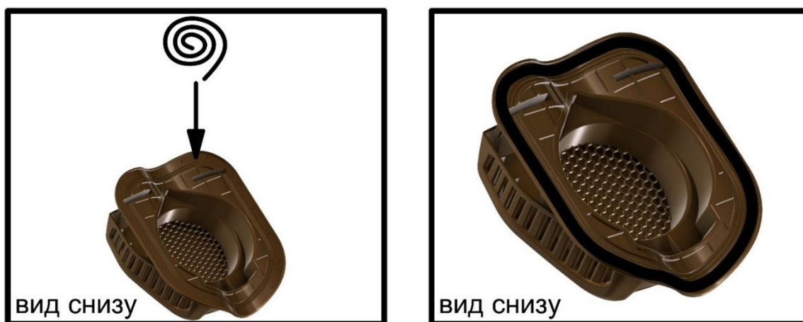
Рисунок Ж.6 – Установка бутылкаучукового шнура в канавку основания аэратора MONTERREY.
