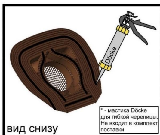
Рисунок Д.7 – Нанесение мастики Döcke для гибкой черепицы на основание аэратора ROOT снизу.
