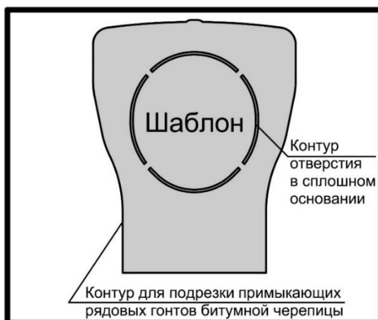
Рисунок Д.4 – Шаблон для вырезания вентиляционного отверстия и подрезки рядовых гонтов.
