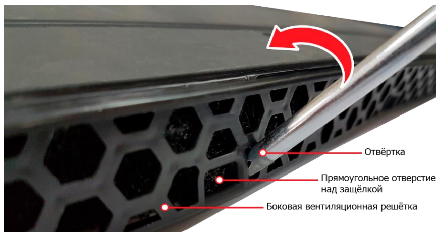
Рисунок Г.11 – Извлечение фильтра из установленного на коньке аэратора.
