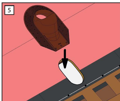
Рисунок И.7 – Установка проходного элемента Döcke ROOT на вырезанное отверстие.
