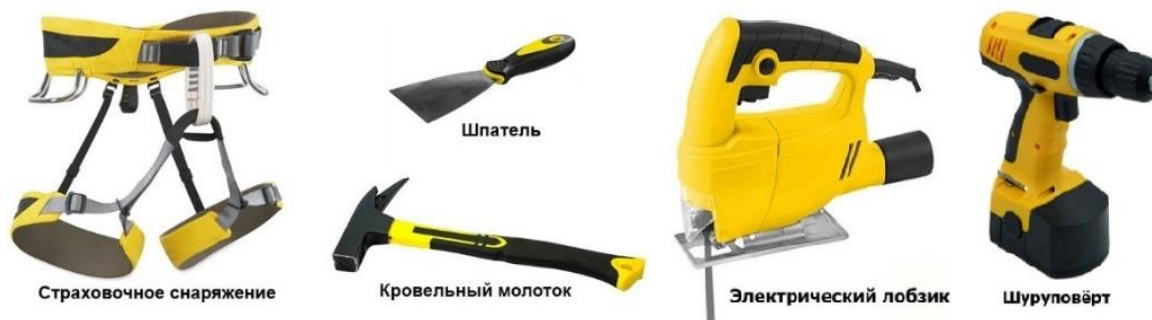
Рисунок И.2 – Перечень инструмента, необходимого для монтажа проходного элемента Döcke ROOT.
