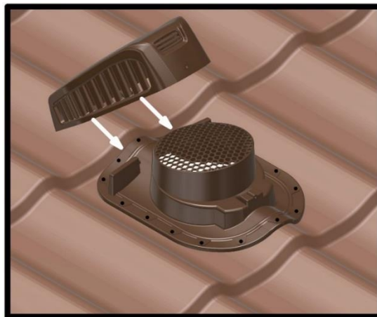
Рисунок Ж.10 – Установка колпака аэратора MONTERREY.
