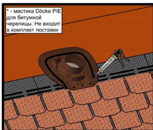
Рисунок Д.12 – Нанесение мастики Döcke для гибкой черепицы на основание аэратора ROOT сверху.
