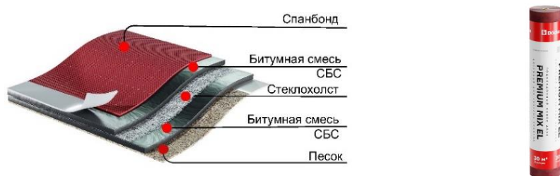
Рисунок 5.12 – Подкладочный ковер с механической фиксацией Döcke PREMIUM MIX EL и его структура.
