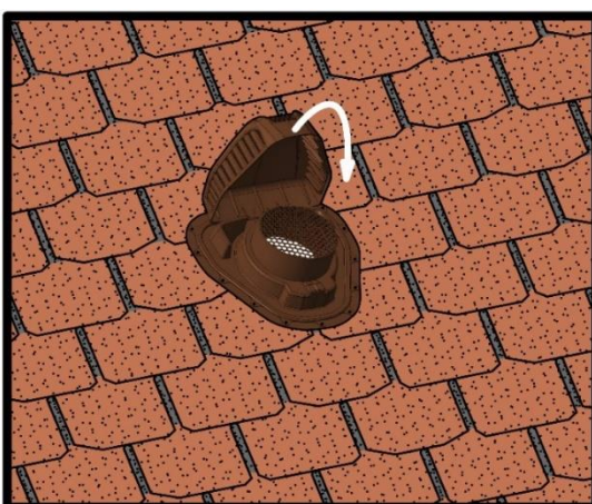
Рисунок Е.11 – Закрытие колпака аэратора NEXT.
