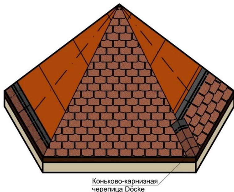
Рисунок Б.41 – Монтаж битумной черепицы Döcke на крышах эркеров и многогранных крышах
