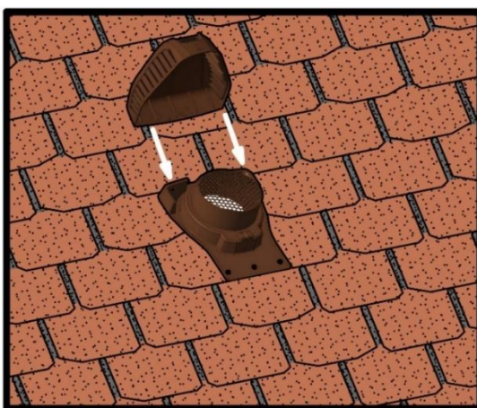
Рисунок Д.15 – Установка колпака аэратора ROOT.
