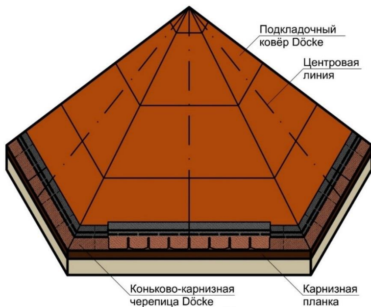
Рисунок Б.40 – Разметка скатов эркеров и многогранных крыш
