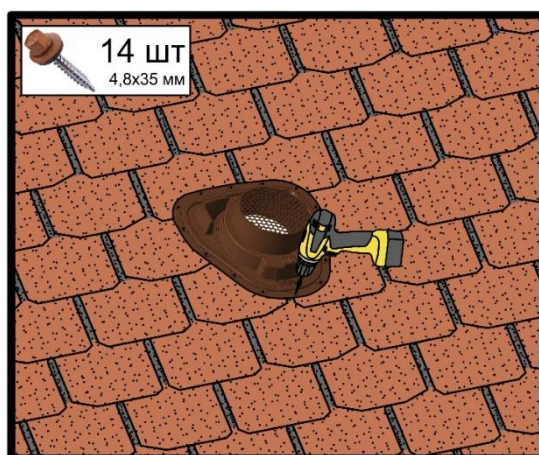
Рисунок Е.8 – Фиксация основания аэратора NEXT саморезами 4,8x35 мм.
