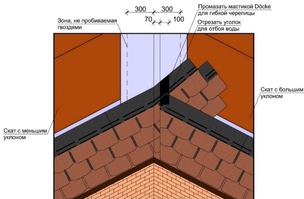
Рисунок Б.31 – Выполнение закрытой ендовы.
