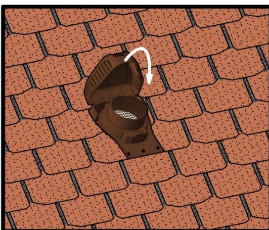
Рисунок Д.17 – Закрытие колпака аэратора ROOT.
