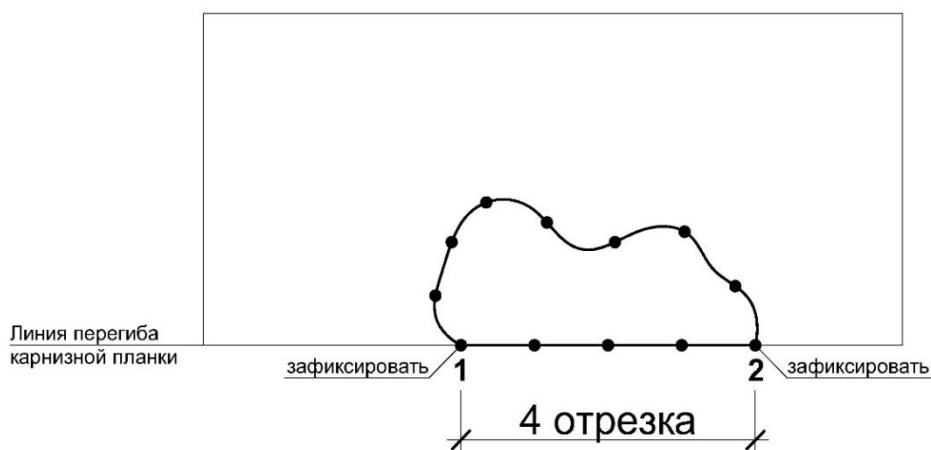
Рисунок Б.16 – Фиксация точек (1) и (2) шнура на скате крыши.
