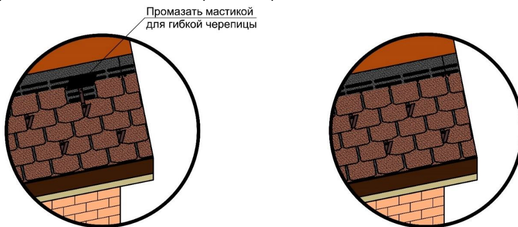
Рисунок В.5 – Промазывание лепестков, накрывающих ножки снегозадерживающих устройств, мастикой для гибкой черепицы при установке снегозадерживающих устройств.
