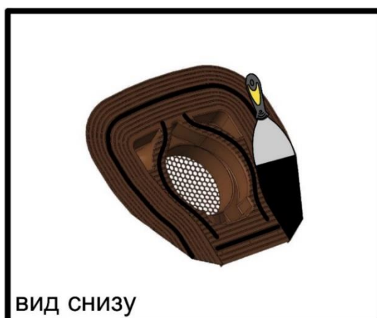
Рисунок Д.8 – Распределение мастики Döcke для гибкой черепицы по основанию аэратора ROOT снизу.
